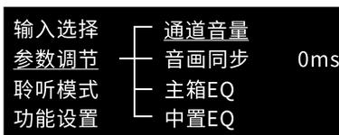
针对每个声道独立的输出电平增益调节,这里针对不同的扬声器布局,显示不同,当扬声器布局中没有的通道,显示为灰色,无法进行调节;
