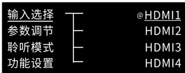
提供所有信号输入的选择功能,并显示音视频源输入口。
